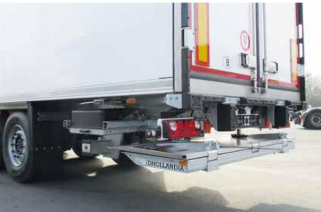
A DH-SM(R) 20 é a **plataforma retrátil mais vendida na gama de capacidade média**. Esta plataforma versátil é capaz de manipular vários tipos de carga, inclusive paletes, até máx. 2000 kg.
